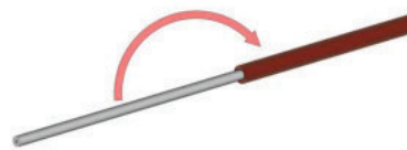
向后折叠屏蔽编织物覆盖在夹克上
