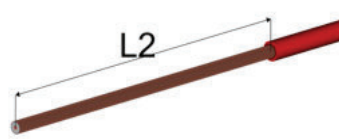
⚠ 仅当使用屏蔽电缆时: 去除电缆护套
