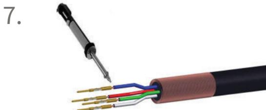
每根导线上各压接或焊接一个触点 (1)
