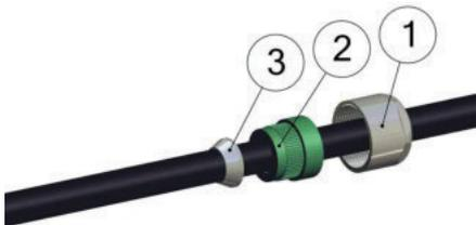
将盖 (1)、夹紧橡胶 (2) 和外锥体 (3) 放在电缆上
