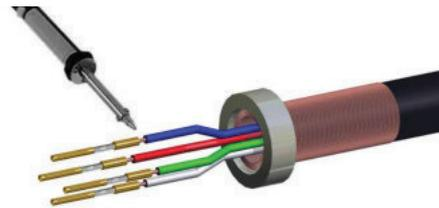
每根导线上各压接或焊接一个触点 (5)
