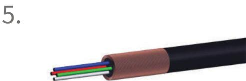
移除电缆上的所有填充元件
