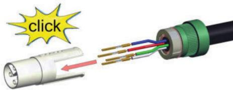
将触点 (5) 完全滑入绝缘部分 (6)，直至触点折断
