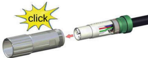
将绝缘部件 (6) 滑入外壳 (7)，直至绝缘部件卡入
