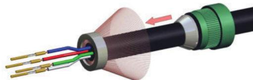
完全加宽屏蔽编织层。将屏蔽编织层下方的外锥体 (3) 和夹紧橡胶 (2) 推向内锥体 (4), 直至屏蔽编织层夹紧在外锥体 (3) 和内锥体 (4) 之间
