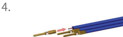
4. 导体上的焊接或压接触点 (2) ⚠️ 焊接时请注意：接触面上不能残留锡焊料
