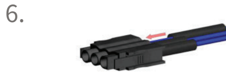
6. 将收缩管 (1) 滑到连接器外壳 (3) 上
