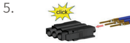
5. 将触点 (2) 完全滑入连接器外壳 (3)，直至触点卡断 轻轻拉动以检查触点是否正确定位并保持在适当位置
