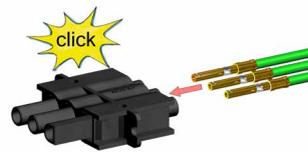
将触点 (2) 完全滑入连接器外壳 (3), 直至触点卡断
