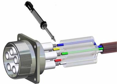
在每个母触点上焊接一根导体。
