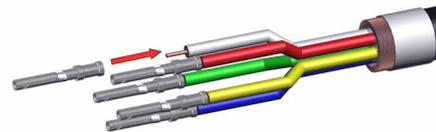
将母触点 (1) 压接或焊接到导体上。
