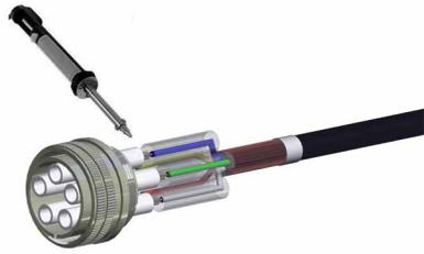
将一根导线焊接到母触点上。
