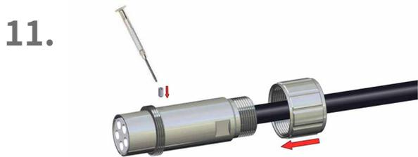
用螺纹销 (6) 固定绝缘插件 (7)，然后将接头 (4) 拧到底座 (5) 上。
