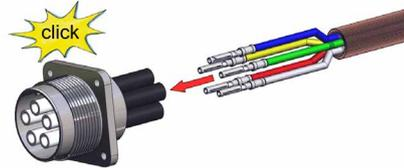
将触点 (2) 完全滑入绝缘管，直至触点卡入到位。
