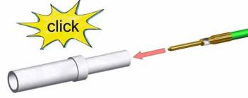
将触点 (2) 完全滑入连接器外壳 (3)，直至触点卡断
