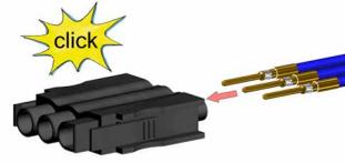
将触点 (2) 完全滑入连接器外壳 (3)，直至触点卡断
