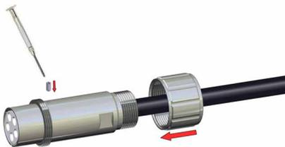
用螺纹销 (6) 固定绝缘插件 (7)，然后将接头 (4) 拧到底座 (5) 上。
