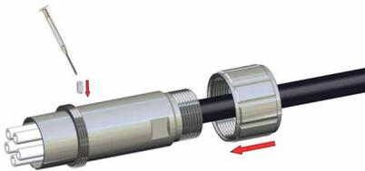
用螺纹销 (6) 固定绝缘插件 (7)，然后将接头 (4) 拧到底座 (5) 上。
