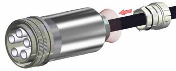
将屏蔽编织层下的密封插件 (2) 完全滑入电缆密封套底座 (3)。
