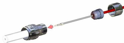
将电缆完全插入绝缘部分 (4)，直至密封插件 (2) 插入外壳 (3)
