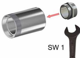
将电缆密封套基座 (3) 拧到外壳适配器 (4) 上。
