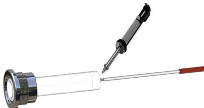
将导体焊接到母触点上或使用电缆接线片将导体与触点连接
