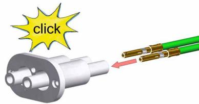
将触点 (2) 完全滑入连接器外壳 (3), 直至触点卡断
