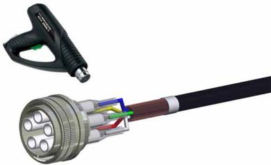
将热缩管放置在绝缘体上。管子应覆盖绝缘体和电线。然后收缩管子。收缩温度100°C。
