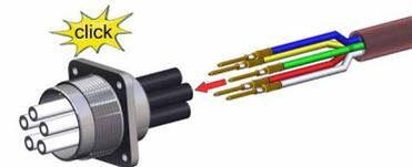
将触点完全滑入绝缘管，直至触点卡入到位。
