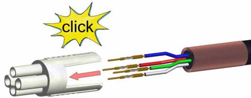
将触点 (1) 完全滑入绝缘部分 (2)，直至触点折断
